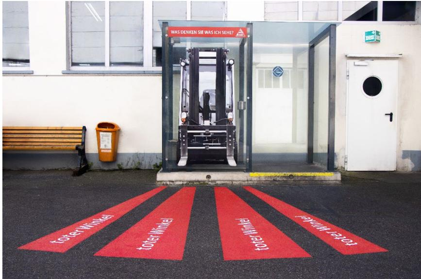
Pie de foto: La visión de los conductores y conductoras de montacargas está muy limitada, lo que ilustran los rayos rojos en el suelo. *Derechos de la fotografía: Grupo Koehler*
