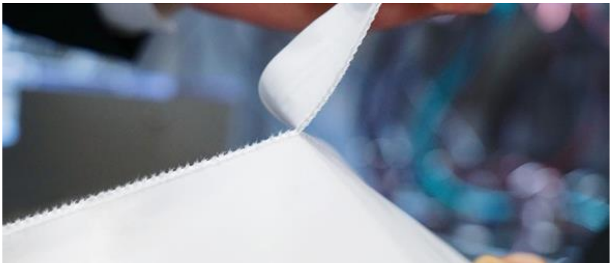
Abbildung: Das HDG-Pressure-Seal-Modul kann das ungestrichene Papier „NexPlus MC“ von Koehler Paper ohne Siegelschicht zu Beuteln verarbeiten. / Quelle: HDG-Verpackungsmaschinen
